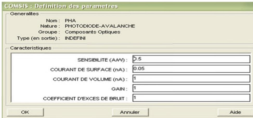
Tableau IV.12 : Paramètres caractéristiques de la photodiode a avalanche.
