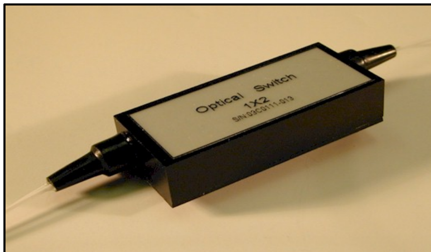
Figure (1.14) : Commutateur électro-optique 1x2 de O/E Land [I.1].
