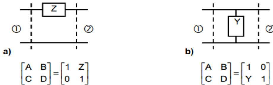
Figure II.28 : Matrice chaîne des systèmes élémentaires à 2 ports.
