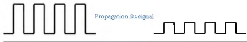
Figure I-19 : Atténuations dans la fibre optique [8]
