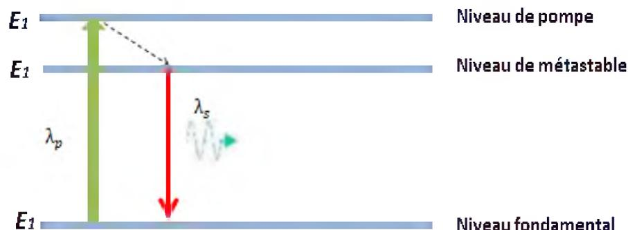
Figure II-3 : principe de fonctionnement d'EDFA
