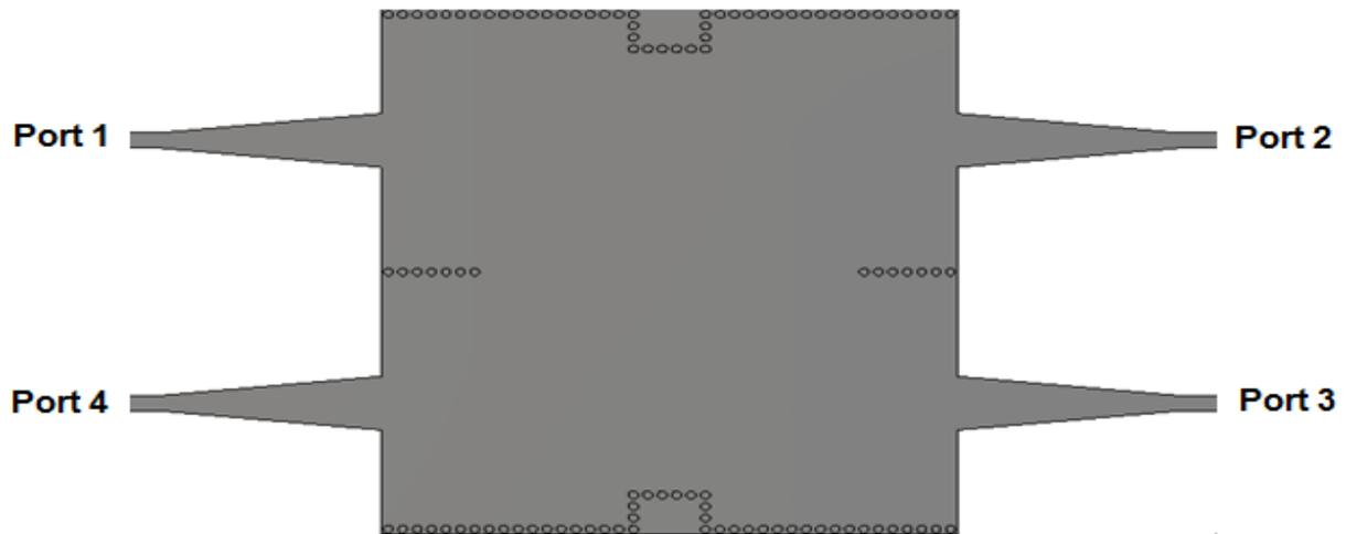
**Figure III.31:** Structure du coupleur SIW en bande S.
