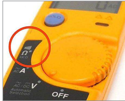
Figure IV.22 : Mode testeur de multimètre [87]
