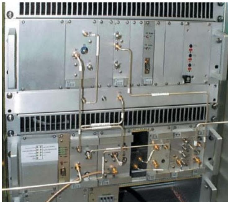
Figure I.10 : Récepteur et générateur de signaux d'un radar ASR-E de contrôle aérien. [1]
