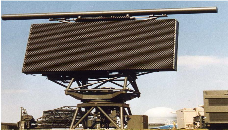
**Figure I.4 :** Antenne à balayage électronique du radar de surveillance aérienne TRS 22XX
