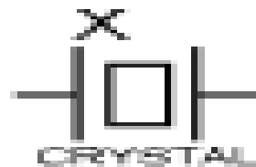
Figure 3.4 : Schéma de QUARTZ
