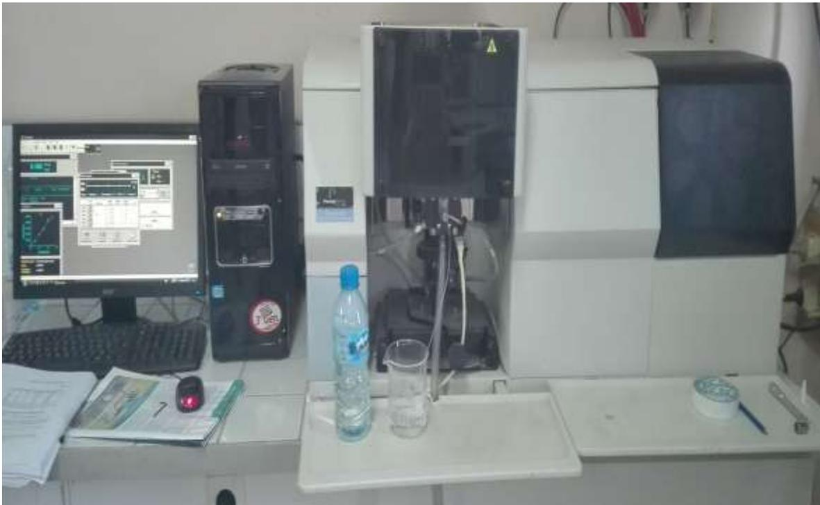
Figure 4 : Spectroscopie d'absorption atomique « Perkin Elmer Instrument AAnalyst 300 »
