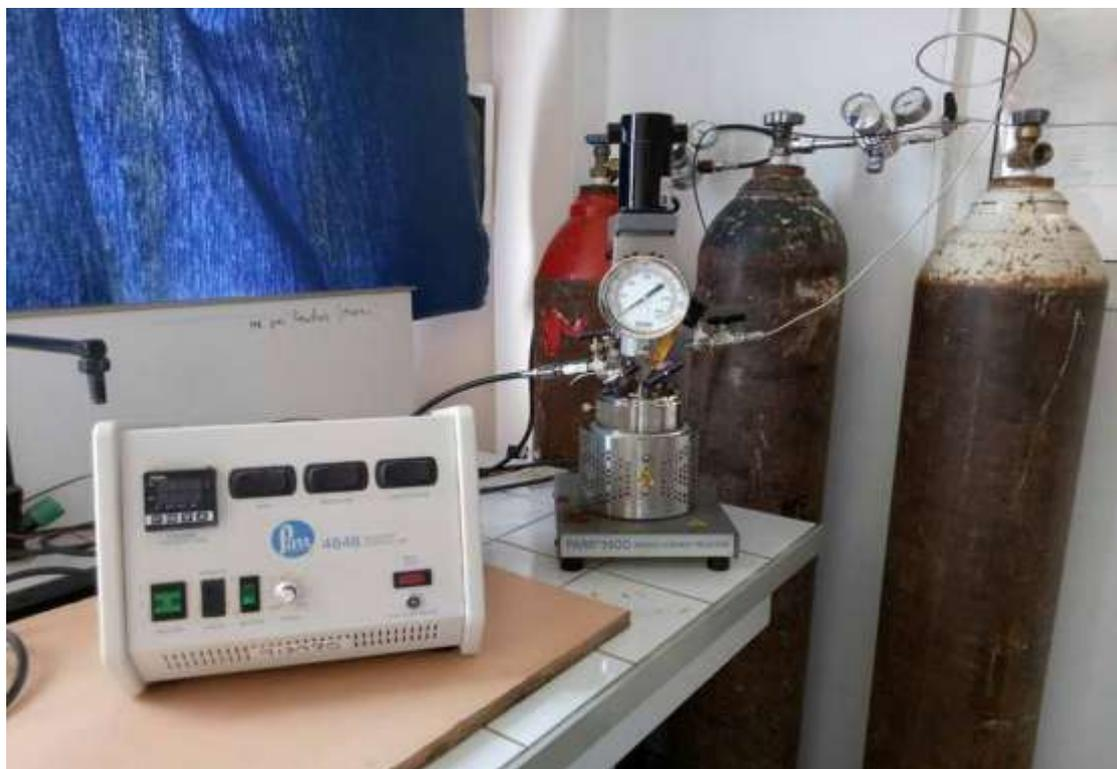
Figure 6 : 2<sup>nd</sup> dispositif expérimental de la réaction de l'hydrogénation de la cinnamaldéhyde en réacteur sous pression
