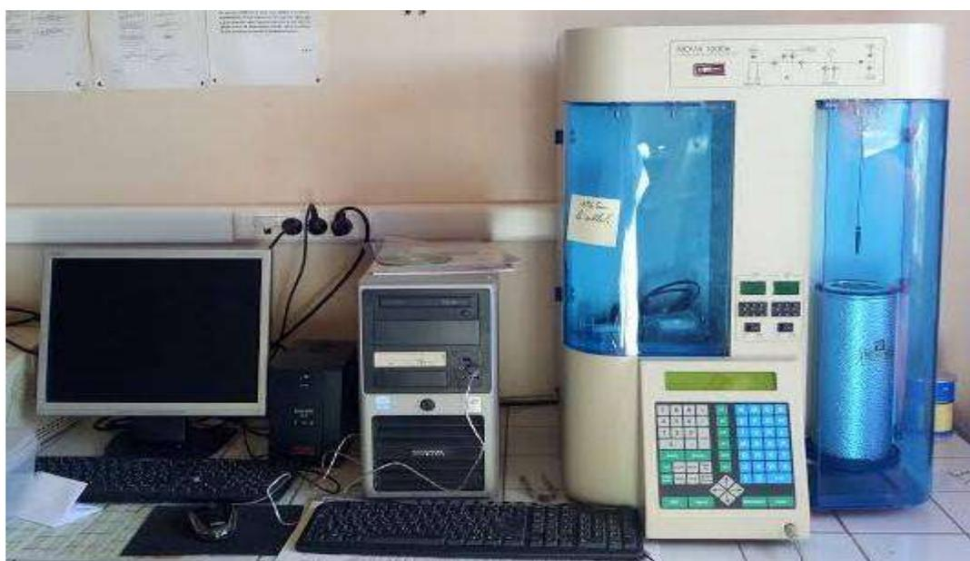
Figure 1 : Appareil d'adsorption/désorption d'azote « Quantachrome NOVA 1000e »
