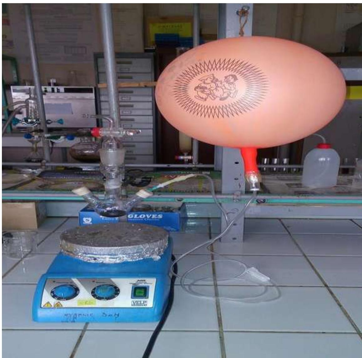
Figure 5 : 1<sup>er</sup> dispositif expérimental de la réaction de l'hydrogénation de la cinnamaldéhyde
