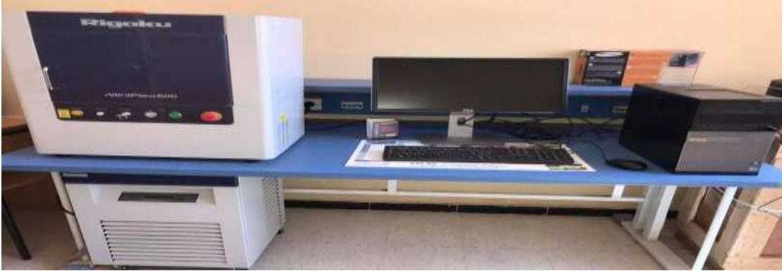
Figure 2 : Diffractomètre des Rayons X « Rigaku Mini Flex 600 »
