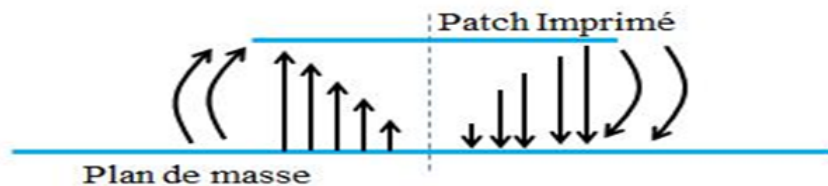
FIGURE 1.9 – Rayonnement d'une antenne patch rectangulaire.
