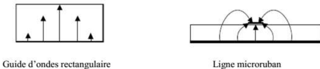
Figure I.24 : Les lignes de champs dans un guide d'onde rectangulaire et dans une ligne micro-ruban de mode fondamental TE_{10} .
