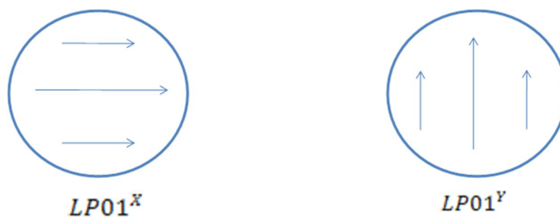
Figure 1.19 : Représentation des modes dégénérés du mode LP01.
