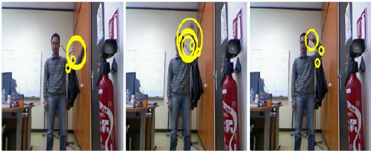
Figure II.3. : Exemple de détection des STIP sur la séquence de geste « Salut ».
