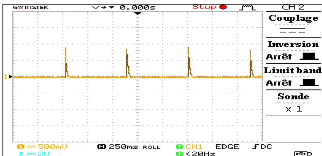
Figure III.7 : Signal de sortie du générateur d'impulsions (unidirectionnel).
