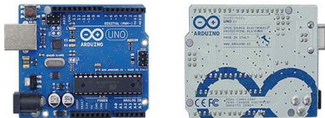
Figure 2.1 : Carte Arduino officielle
