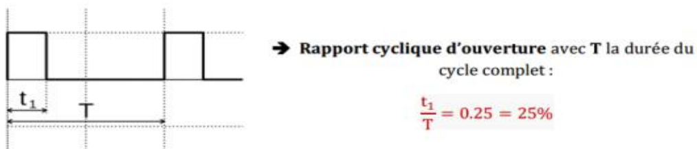
Figure 2.13 : Principe d'un signal de commande par PWM
