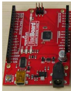
Figure 2.2 : Carte Arduino Compatible
