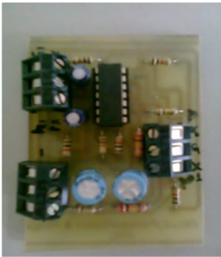
Filtre réjecteur de l'interférence du réseau électrique (50 Hz) en double-T
