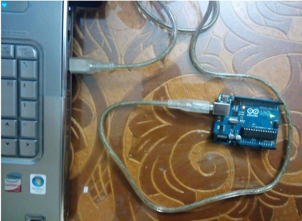
Figure IV. 6 : Alimentation de l'Arduino
