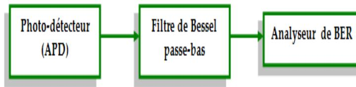
Figure III.10. Schéma du bloc d'un récepteur optique ONU.
