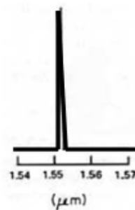
Figure I.3. Spectre d'émission d'une diode laser [2].
