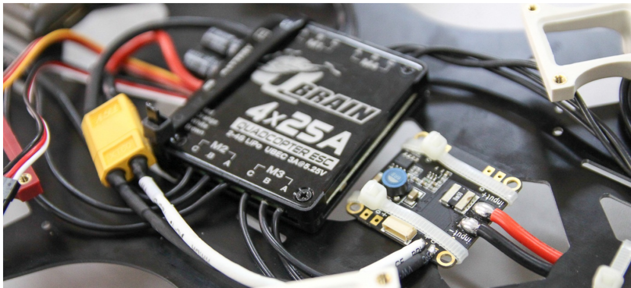
Figure 3.11: Montage du module de puissance
