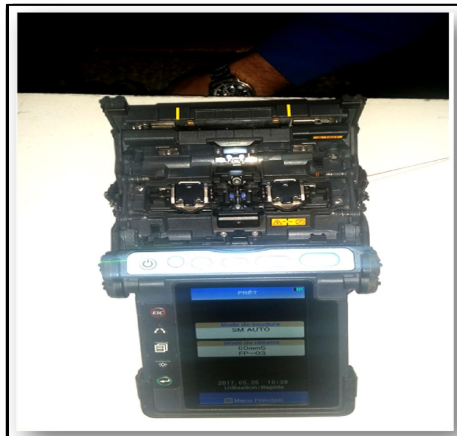
Figure IV.15 : Une soudeuse de fibre optique
