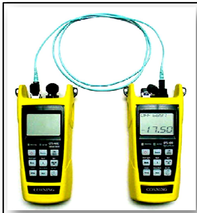
Figure IV.27 : Testes par un émetteur et un récepteur
