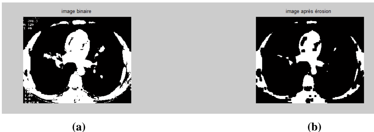
Fig.III.6 Une érosion appliquée sur image binaire avec es=3 (a) image originale ; (b) image érodée
