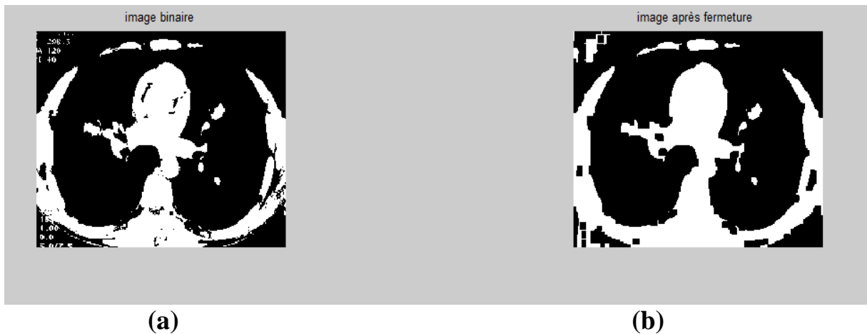
Fig.III.9 Une fermeture appliquée sur image binaire avec es=3 : (a) image originale ; b) image après fermeture
