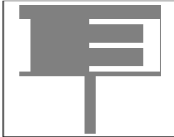
FigureII. 26. Antenne de forme EF : avec \epsilon_r = 4.32 , h = 1.53 mm avec 2 couches de cuivre de 35 \mu met plan de masse (80mm \times 60mm).
