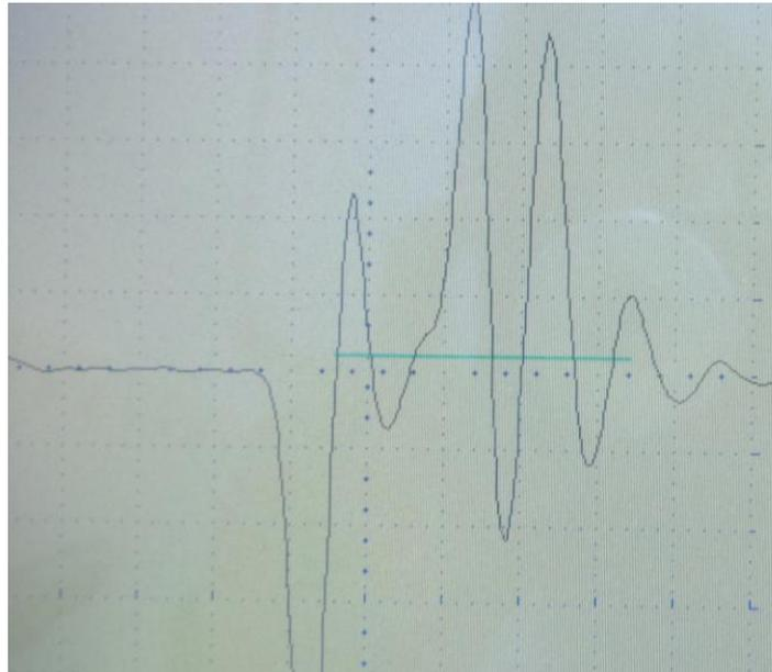
Figure III.14: signal reçu provenant d'un implant dentaire en Titane
