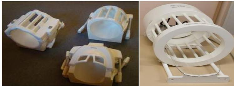
Figure1.3 : Antenne cage d'oiseau pour la tête
