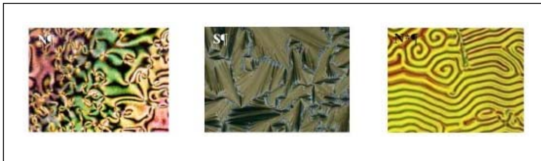
Figure III.7 : Exemples de textures caractéristiques des mésophases : N-nématique ; S-smectique et N*-cholestérique.
