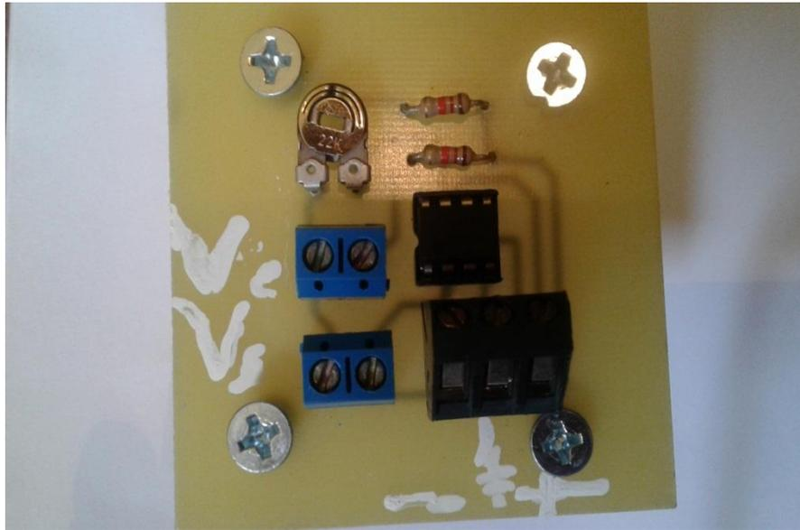
Figure III.3 Circuit imprimé du circuit d'offset
