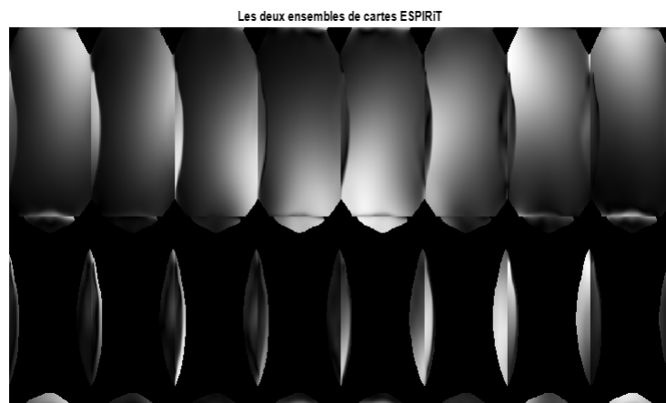
FIGURE III.15 – Influence du FOV réduit sur la carte de sensibilités obtenue à partir d'une matrice de calibration. Carte de sensibilité pour une image à FOV réduit utilisant un sous échantillonnage 2D.
