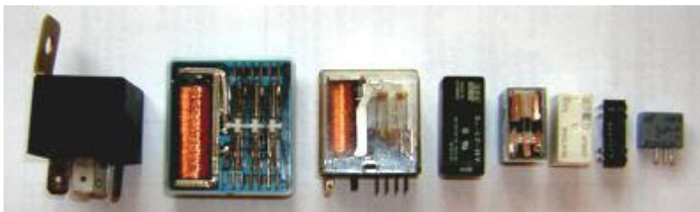
Figure3.7 : les différents relais.
