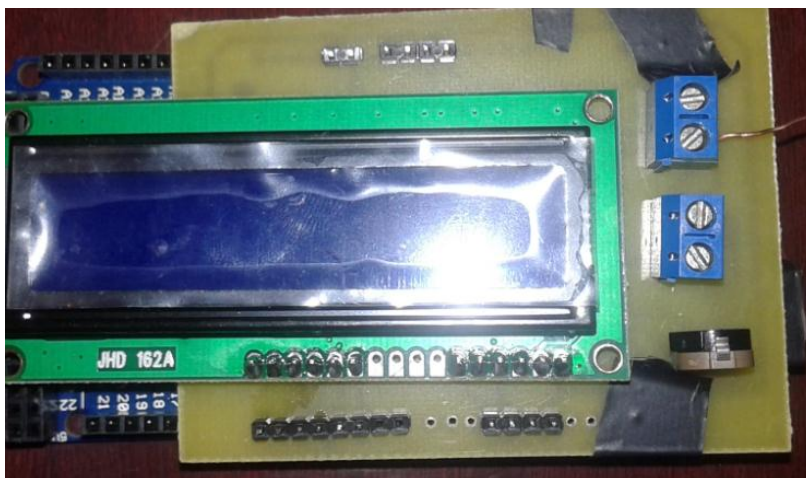
Figure4.11 : carte arduino avec l'afficheur LCD
