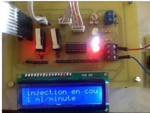
**Figure 4.10 : Injection en cours mode B**
