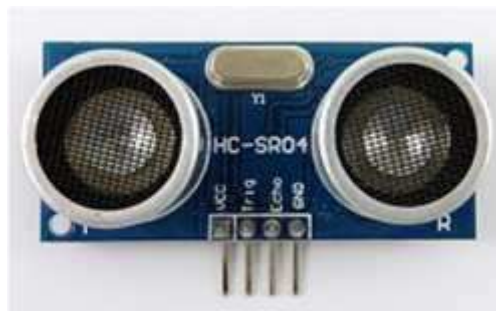
Figure (3-21) : Module HC-SR04
