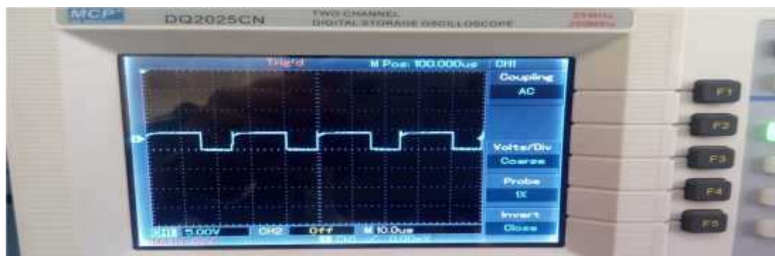
Figure (3-5) : Le signal à la sortie de NE555
