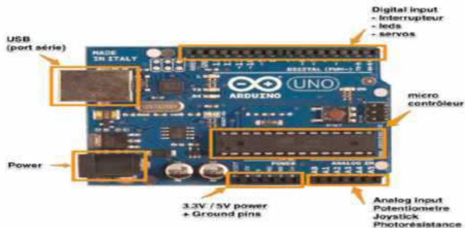
Figure (3-25) : Les composants de la carte Arduino-Uno
