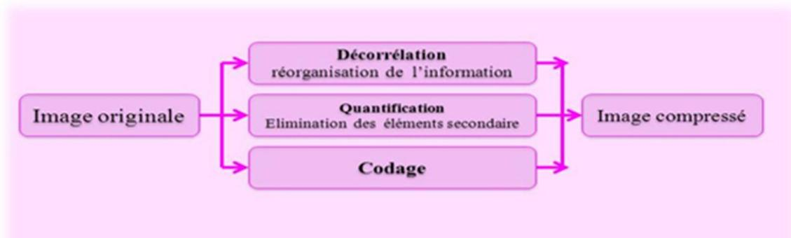
**Figure I.1 :** Schéma général de compression des images
