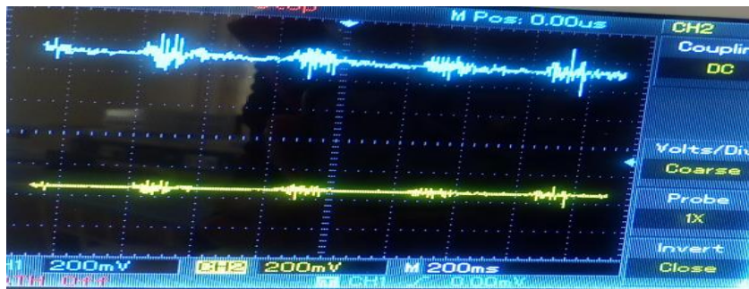
Figure III.3 : la sortie du filtre passe bande.
