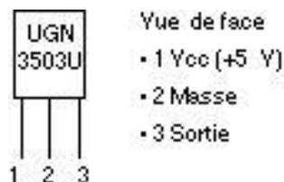
**Figure 3.1 : brochage du capteur à effet Hall UGN3503U**
