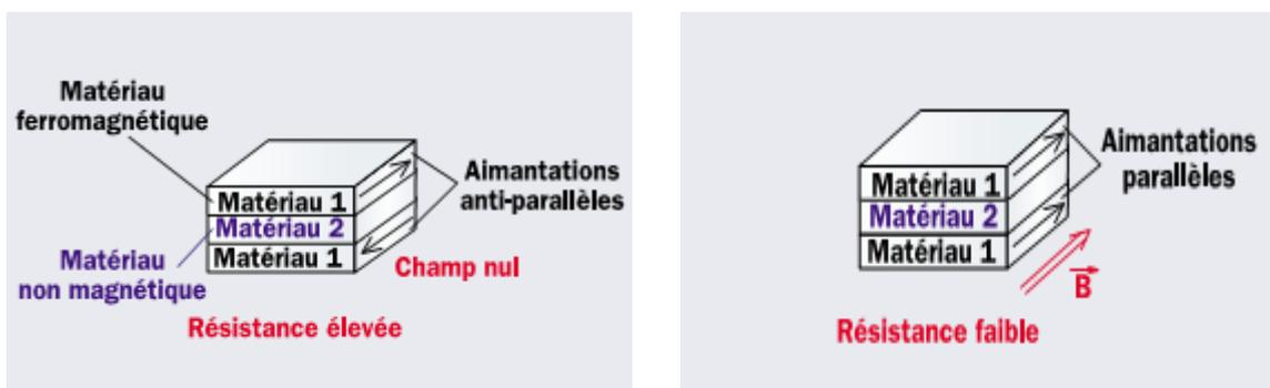
Figure 2.7 : Diminution de la résistance à l'application d'un champ  $\vec{B}$
