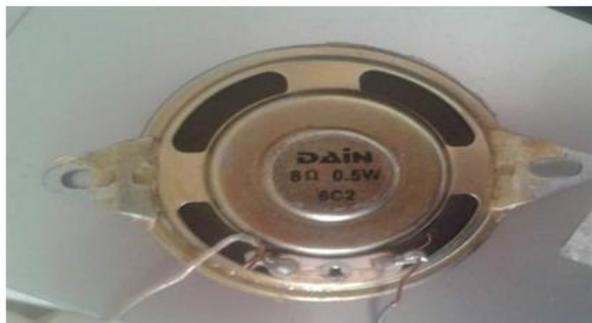
Figure 4.11 : haut parleur utilisé dans le circuit
