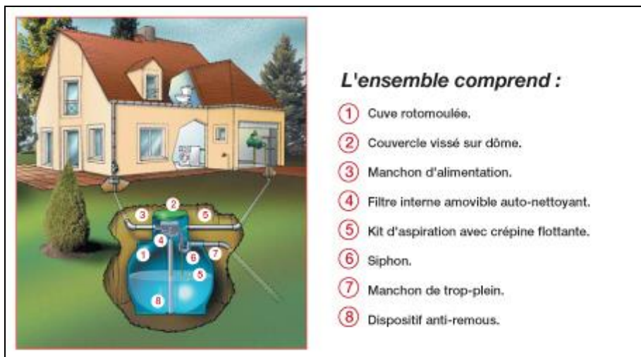
Figure VI.22 : Schéma de récupération des eaux de pluie
