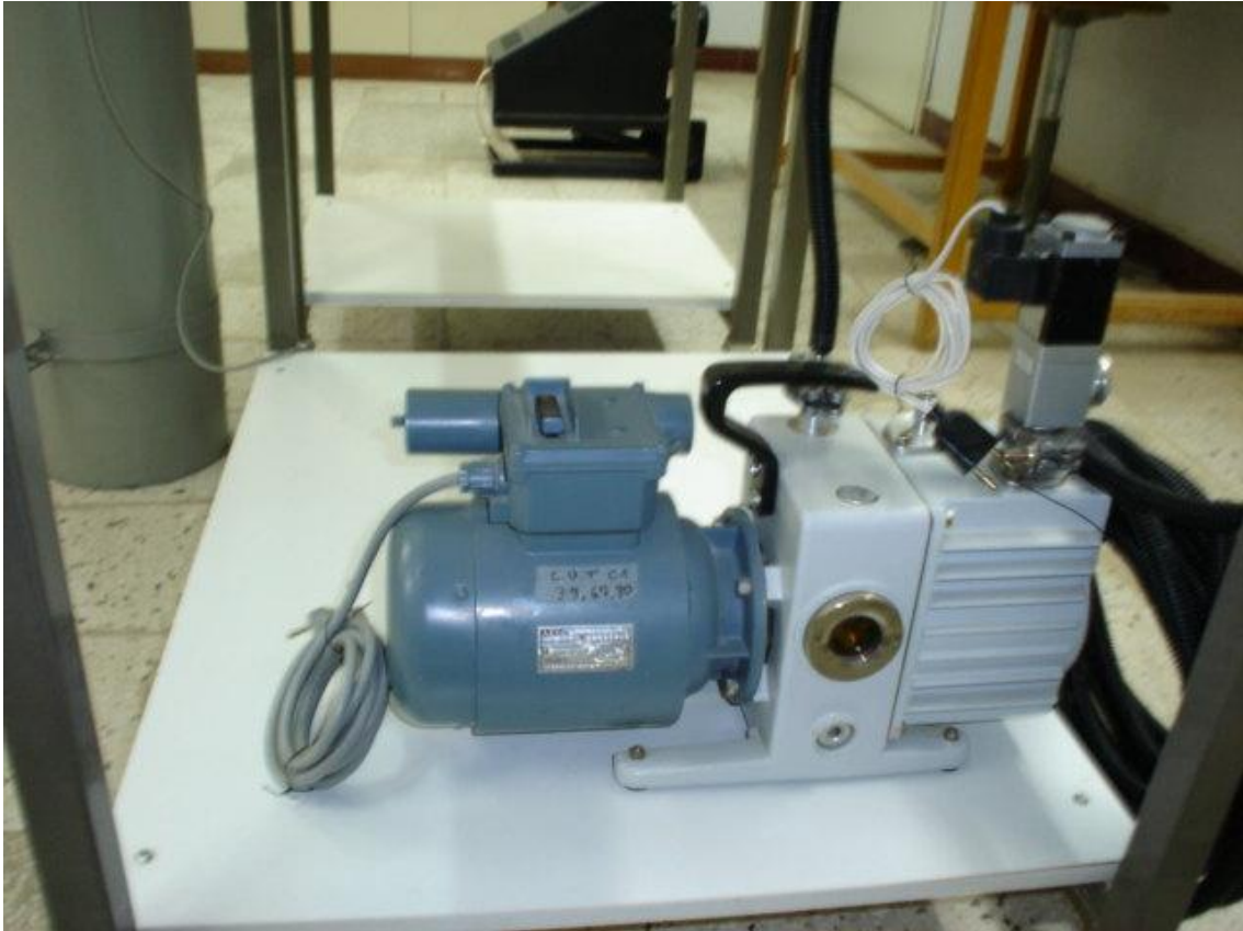
Photo n °6 : vue du groupe de pompage et son dispositif de mesure de pression (Laboratoire d'optique - Université de Tlemcen).
