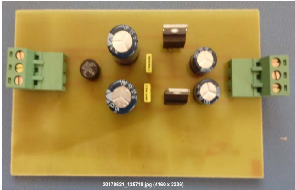
Figure. IV-17: circuit imprimé d'alimentation
