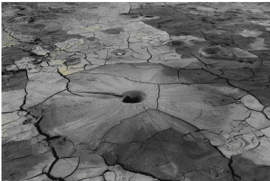
Figure 3. 7 : Ebullitions de sable au Comté de Nantou en Taiwan ( Dr Hsein, 2002).
