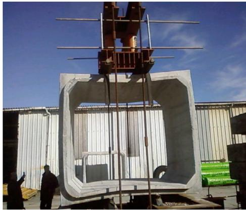
**Figure 4.1** Essai in situ d'un OA préfabriqué
