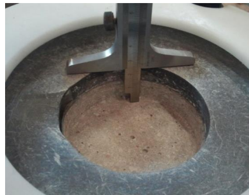
Figure 3. 34 – Mesure de la profondeur du Grignotage
