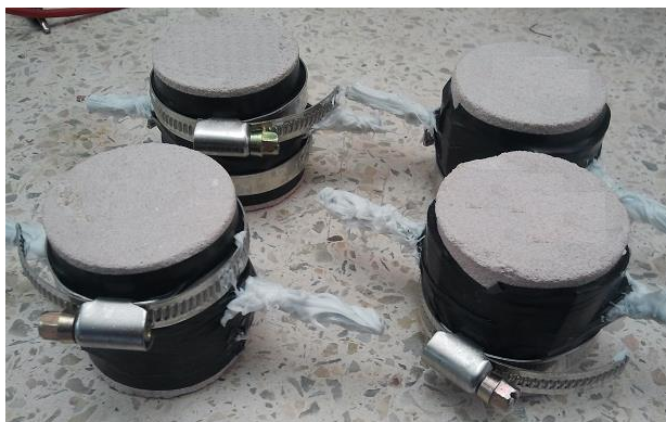
Figure 3. 18 – Carottes en briques servant à la mesure électrique.
