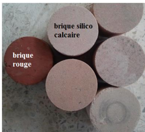
Figure 3. 11 – Carottes de briques de 45 mm.
