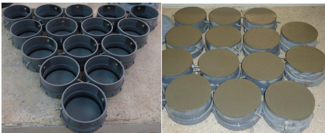
Figure 3. 14 – Eprouvettes de mortier de 11cm de diamètre.
