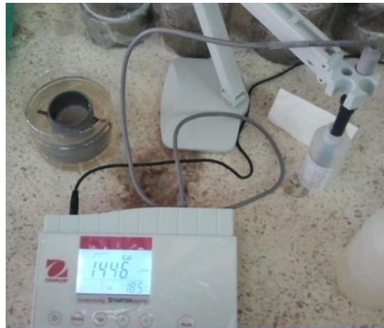
Figure 3. 25 – Calibrage du conductimètre avec une solution de KCl.
