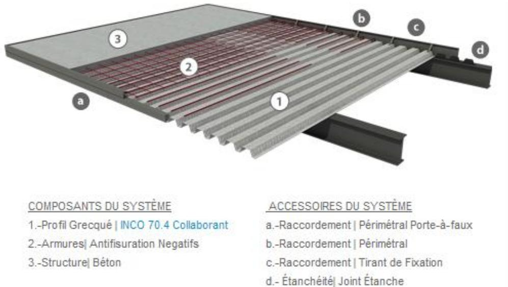
**Figure 51** : composants de plancher collaborant
