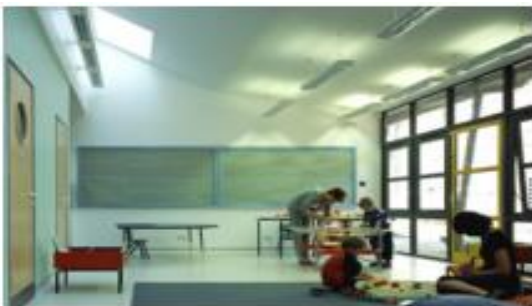
Figure 1.23: Exemple d'éclairage naturel contrôlé avec éclairage d'appoint artificiel, Netley School Autistic Ressource Base (source: archdaily.com)
