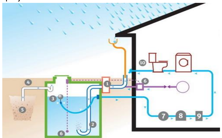
Figure 3-25 : Système de récupération des eaux de pluviales
