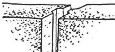
**Figure 149** : Détail constructif des joints de dilatation
