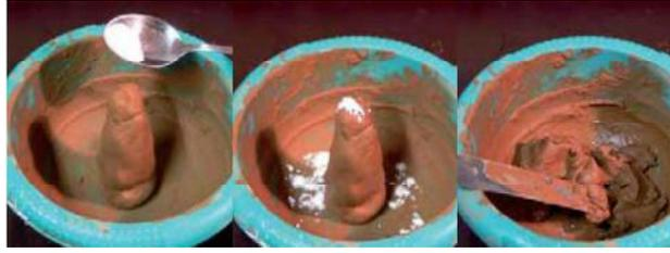
**Figure 63** Pâte argileuse devient liquide avec une pincée de dispersant
