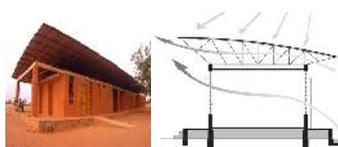
Un chaînage en béton armé reprend les charge de la charpente et les transmet au mur en BTC
