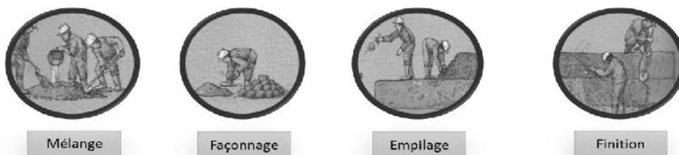
**Figure 57** Cycle de production de la technique de bauge
