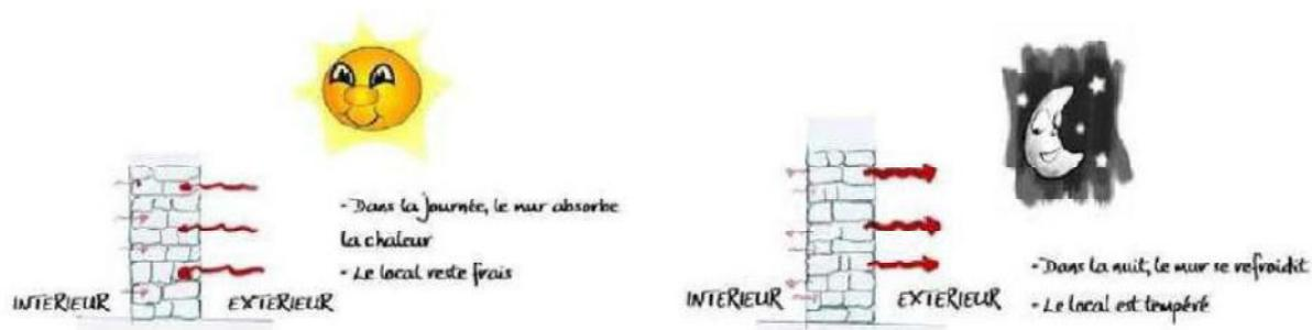
**Figure 20** inerte thermique d'une paroi en pierre
