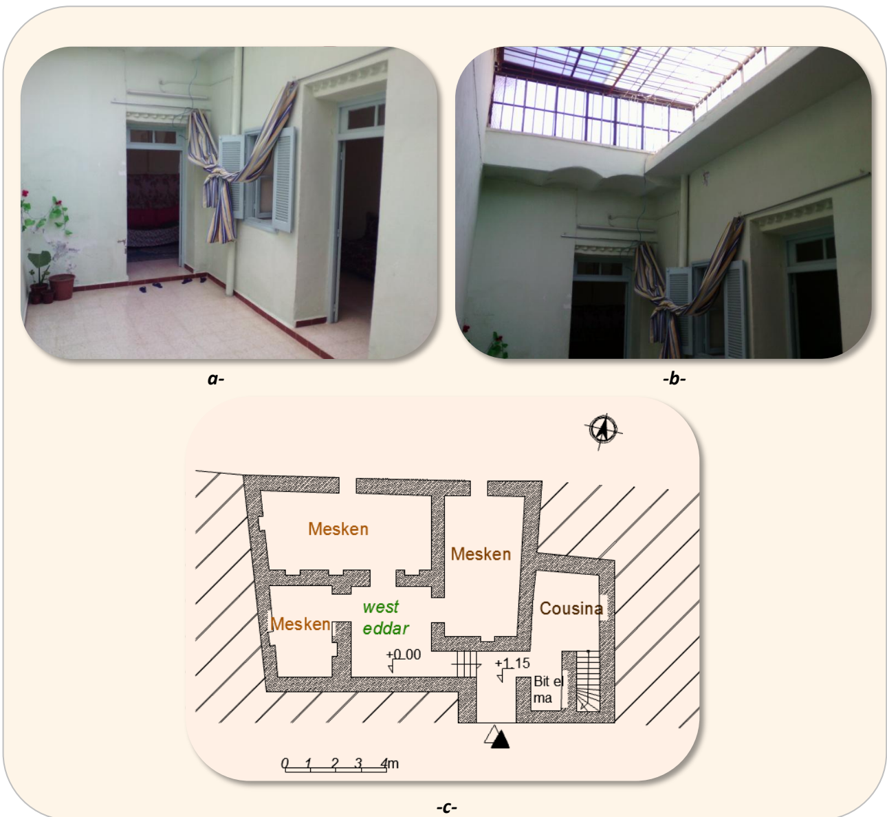
Figure 70 : maison N° 023. -a- west eddar.-b- photo d'une pièce.-c-plan R.D.C. (Source : auteurs)
