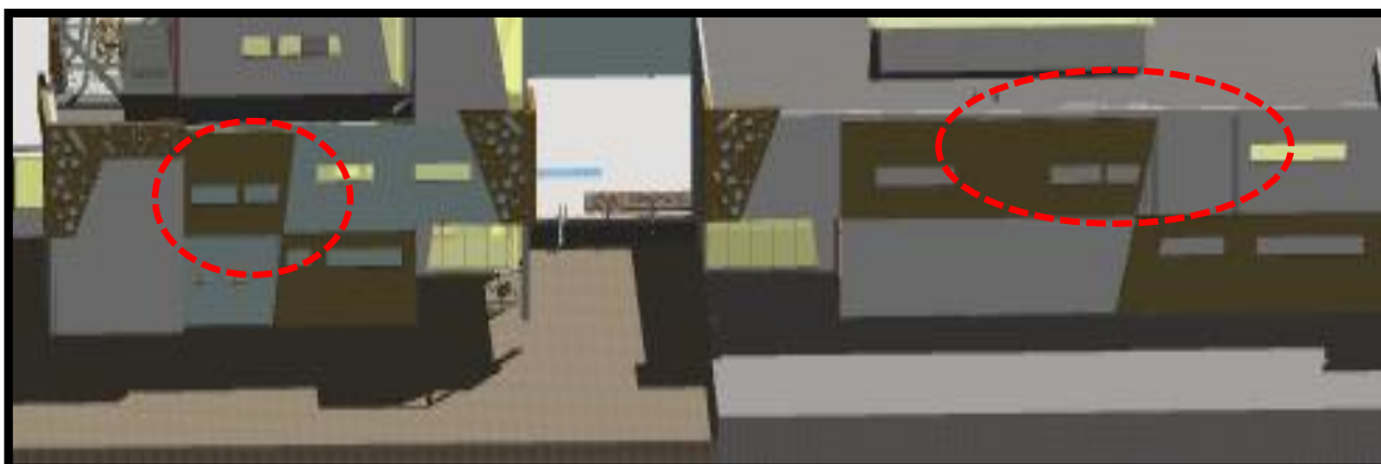
Figure (97) : le stuc beige au niveau des façades du projet
