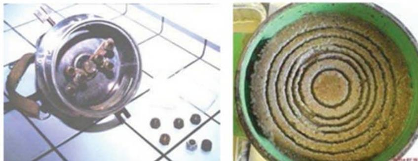
*Figure 2.4 : Appareillage d'érodimètre à jets mobiles.*
