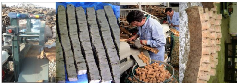
Figure 37: Les étapes de découpage et tubage dans le processus de fabrication des bouchons (Photos Ghalem, Beni Mester 2012 ; SIBL 2015)
