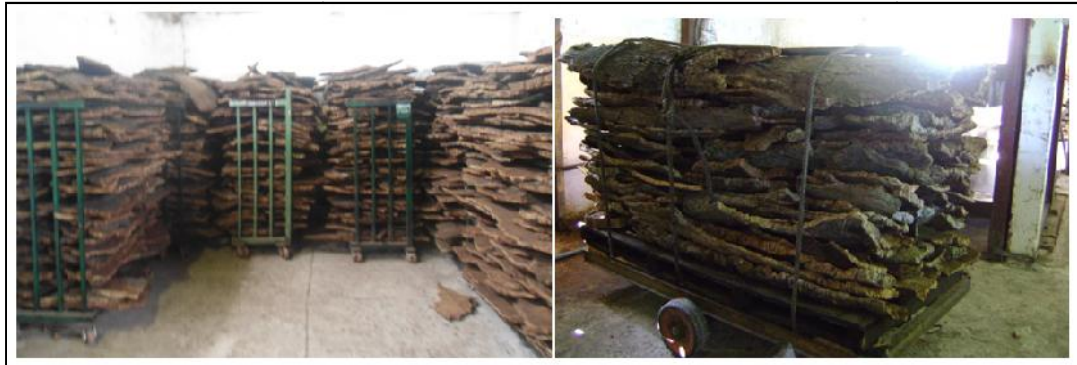
Figure 40: Bouillage et stabilisation des planches au niveau de l'usine (Photos Ghalem, Jijel 2015)
