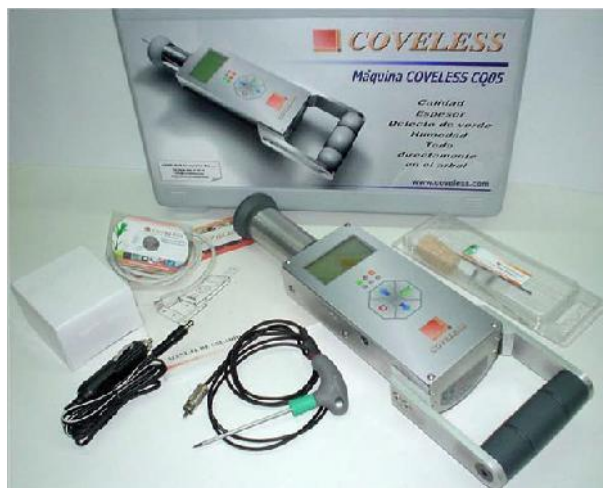
Figure 25: Dispositif d'estimation de la qualité du liège sur pied COVELESS CQ 05 (Piazzetta, 2007)
