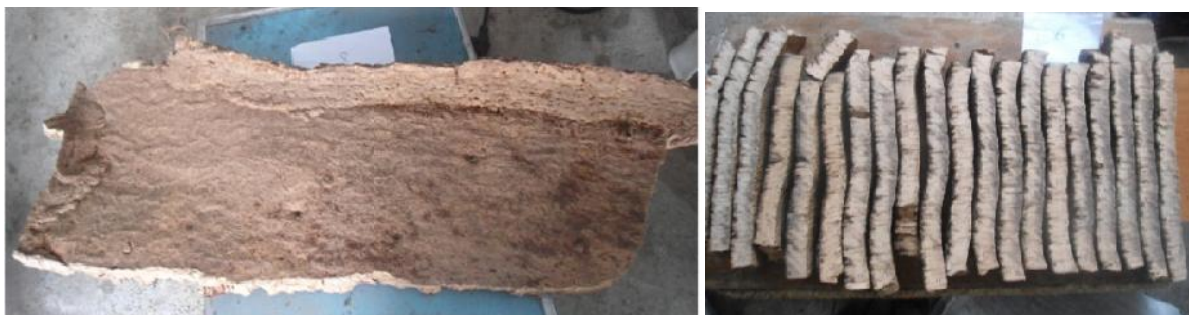
Figure 41: Planche de liège destinée à la fabrication des bouchons (Photos Ghalem, Beni Mester 2012)
