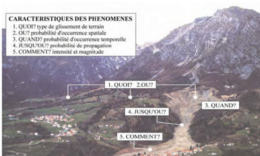
Figure 1.1 – Concepts, termes et questions à résoudre pour l'analyse et le zonage du risque « glissement de terrain. Exemple du glissement-coulée de Tessina, Belluno, Italie » (Durville J.L.,1996)
