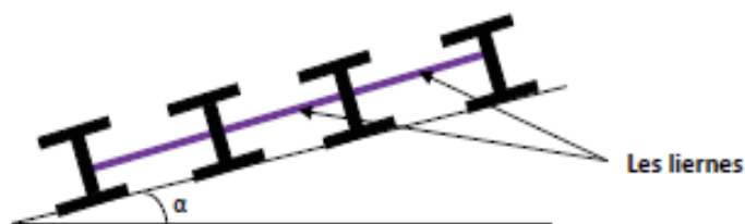
Figure.3.8 : Coupe transversale des liernes.
