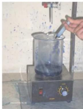
**Figure 3.6:** Essai de bleu méthylène.
