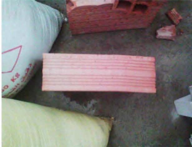
**Figure 3.2 :** Exemple de brique voilée.
