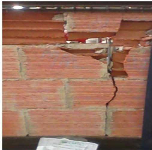
**Figure 4.5 :** Rupture par éclatement du bloc supérieur
