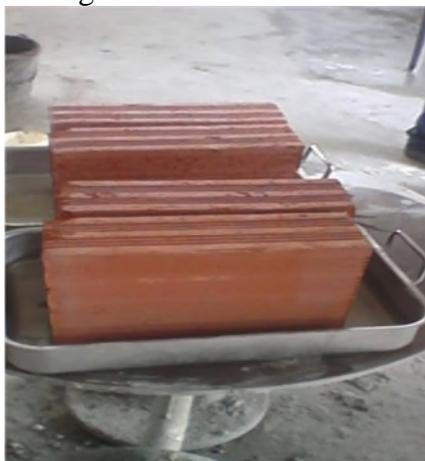
**Figure 3.4 : L'essai d'absorption.**
