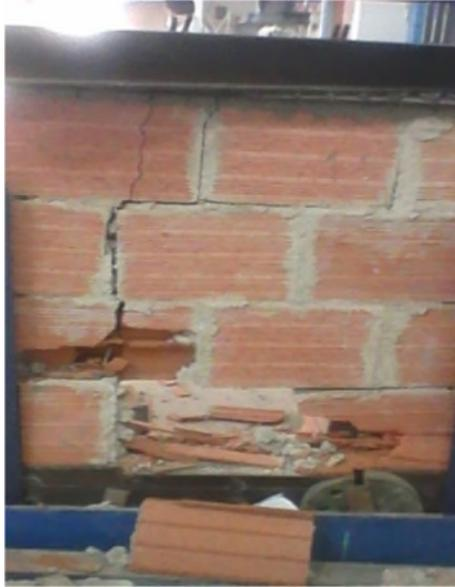
**Figure 4.3 :** La fissure parallèle à la direction de la charge (mode 1)
