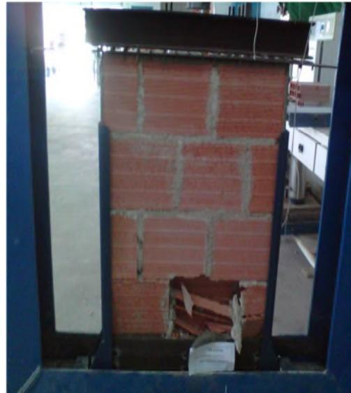
**Figure 4.1 :** La rupture est éclatement de la brique
