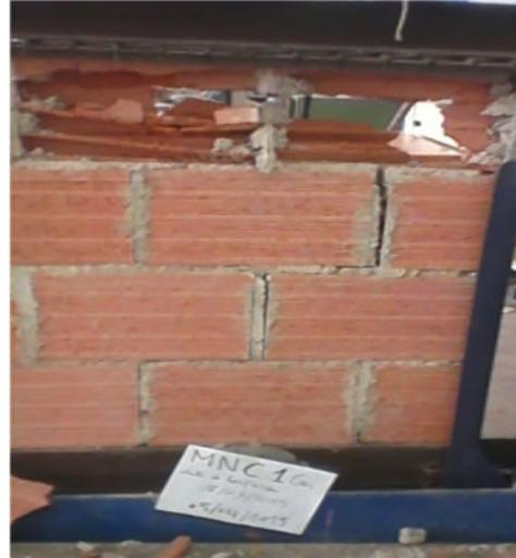
**Figure 4.3 :** la rupture par dégradation sur des joints de mortier
