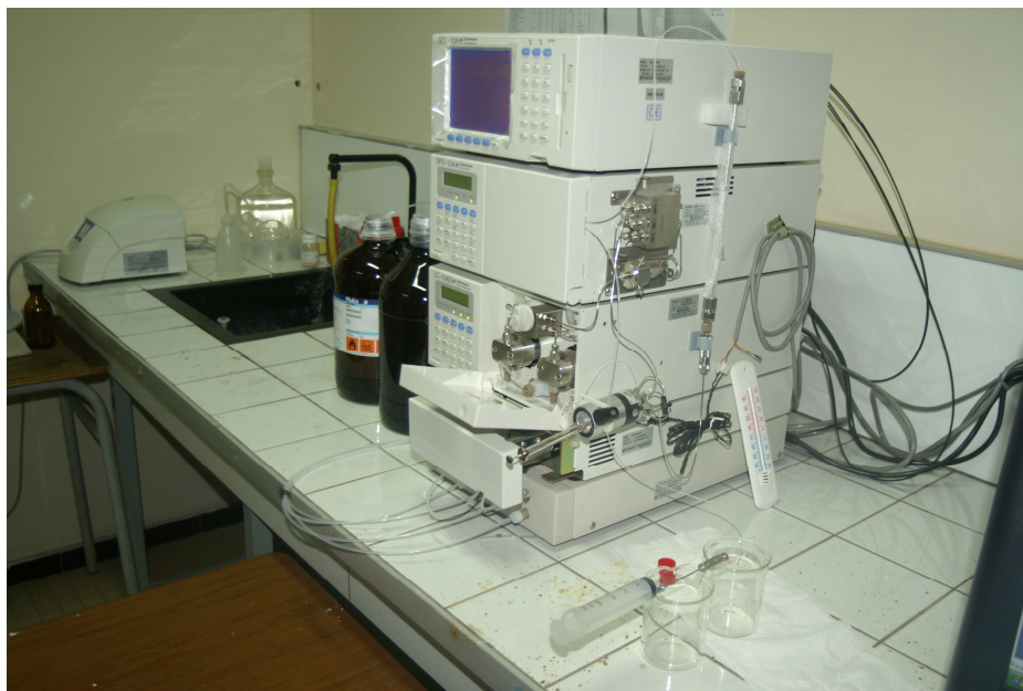
Figure 2.1: Système RP-HPLC du laboratoire de recherche « Spectrochimie et Pharmacologie Structurale ».
